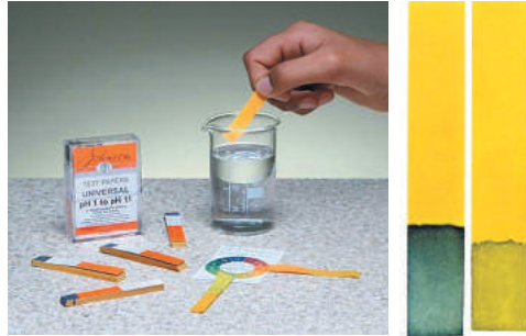
Мал. 31.4. Універсальний індикатор може не лише виявляти кислоти або основи, але й визначати їхні концентрації
