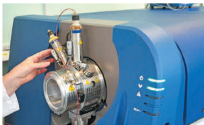
Мал. 41.3. Мас-спектрометр — прилад для визначення відносних атомних і молекулярних мас
