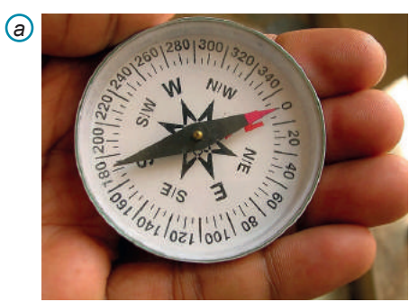
Мал. 56. Компас (а) та як він реагує на магнітне поле Землі (б)
