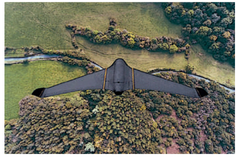
Мал. 46. Безпілотні літальні апарати для аерофотографування
