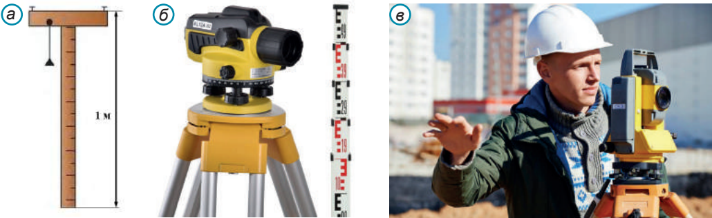
Мал. 58. Прилади для визначення відносної висоти точок: а – шкільний нівелір; б – оптичний нівелір з рейкою; в – теодоліт
