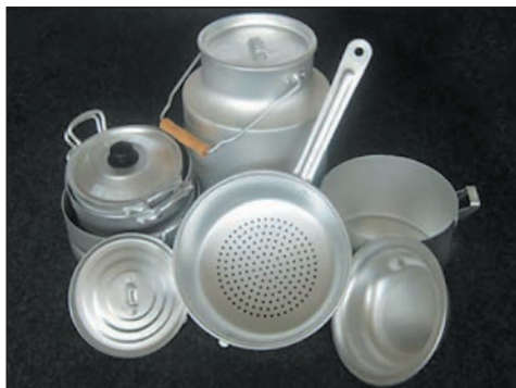
Мал. 4. Алюміній дуже поширений у природі. Він легкий та добре піддається формуванню, литтю, механічній обробці. Алюміній має високу тепло- та електропровідність, стійкість до корозії. Вироби з нього використовуються не тільки в промисловості, а й у побуті.
