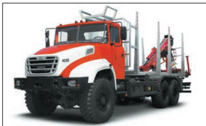
Мал. 3. Лісовоз КрАЗ-6233. КрАЗи проєктувалися як автомобілі для важких умов експлуатації. Вони перевозять будівельні матеріали, руду, ліс, доставляють людей і крупногабаритні вантажі незалежно від наявності доріг, погодних та інших умов.
