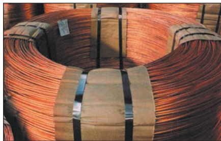
Мал. 2. Мідні дроти. Завдяки високій електропровідності мідь використовується в електротехніці для виготовлення дротів, кабелів, струмопровідних частин електротехнічної апаратури.
