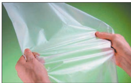
Мал. 6. Поліетилен — досить міцний матеріал. Плівку з нього можна згинати, м'яти, але важко порвати. Поліетилен не проводить електричний струм. Він є стійким до впливу кислот, лугів. Окремі різновиди поліетилену застосовуються у виробництві бронжилетів і навіть броньованих автомобілів.
