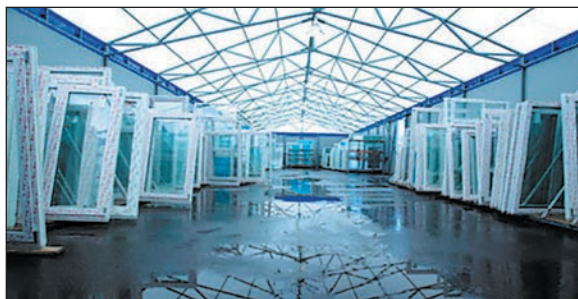
Мал. 4. Пластикові вікна забезпечують високий рівень тепло- і шумоізоляції. Серед інших переваг — довговічність, стійкість до всіх видів атмосферних впливів, естетичний зовнішній вигляд, простота в експлуатації, невисока ціна. Серед недоліків — складність у ремонтванні.
