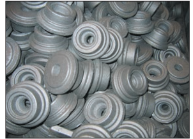
Мал. 2. Вироби з високоміцного сірого чавуну. На сировину та паливо припадає до 90% усіх витрат при виробництві чавуну. Для того щоб виплавити 1 т цього металу, потрібно 1,2—1,5 т коксівного вугілля, 1,5 т залізної руди, понад 0,5 т флюсових вапняків, 200 кг марганцевої руди і до 30 м 3 води.
